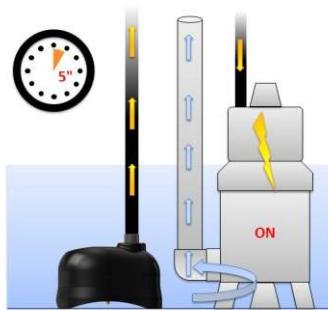
Il Crab avvia la pompa dopo **5 secondi** che i sensori hanno rilevato la presenza d'acqua per lasciare che la pompa si adeschi
